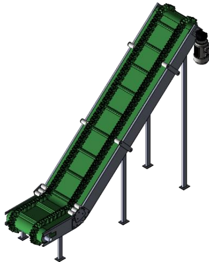
Gambar 3.3. Unit Pemindah (Belt Conveyor)
