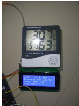
Gambar 4. 4 Pengujian kalibrasi sensor Thermocouple type-K
