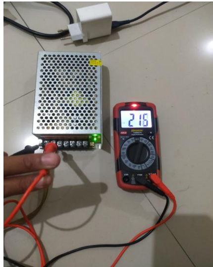
Gambar 4. 1 Pengukuran Tegangan Masukan Power Supply
