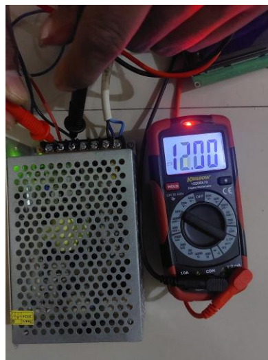
Gambar 4. 2 Pengukuran Tegangan Keluaran Power Supply
