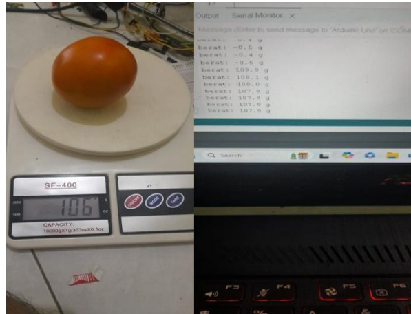
Gambar 4. 5 Kalibrasi ketiga Loadcell HX711
