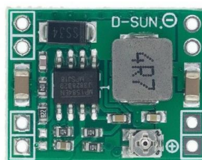
Gambar 2. 16 MP1584EN Mini DC-DC Step Down Module Sumber : [9]
