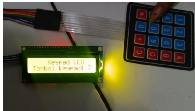
Gambar 4.3 Hasil Pengujian Keypad 4x4
