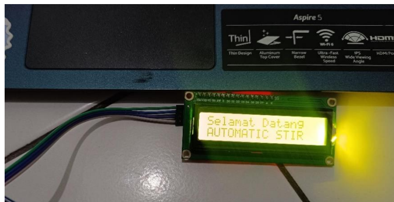
Gambar 4.2 Hasil Pengujian LCD 16x2
