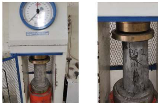
Gambar 3.10. Proses pengujian kuat tekan dan model kerusakan benda ujinya
