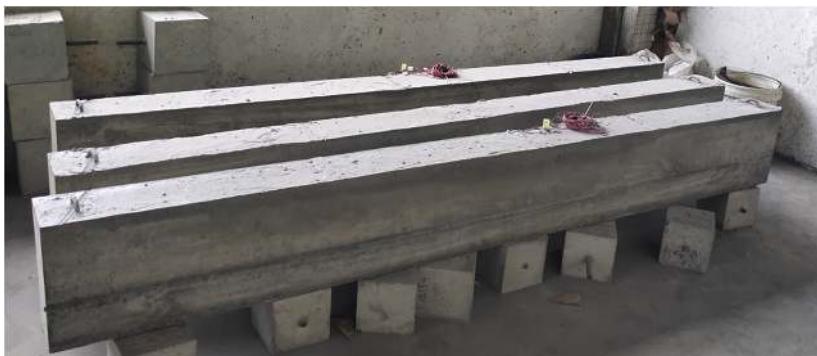
Gambar 3.24. Hasil pengecoran balok tanpa perkuatan (BN)
