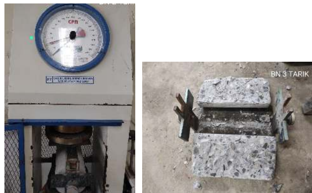
Gambar 3.11. Proses Uji tarik tak langsung dan model kerusakan benda uji
