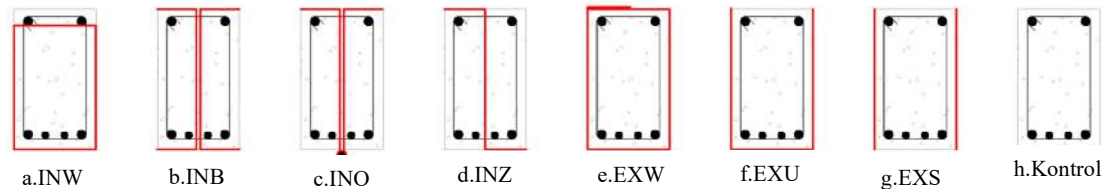
Gambar 2.7. Konfigurasi model benda uji perkuatan geser (Moradi et al., 2020)
