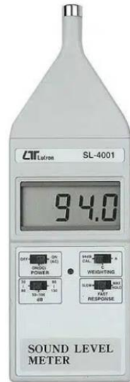
Gambar 3. 3 Sound Level Meter yang sudah di kalibrasi (E 10 04 41) Sumber: Google, 2024
