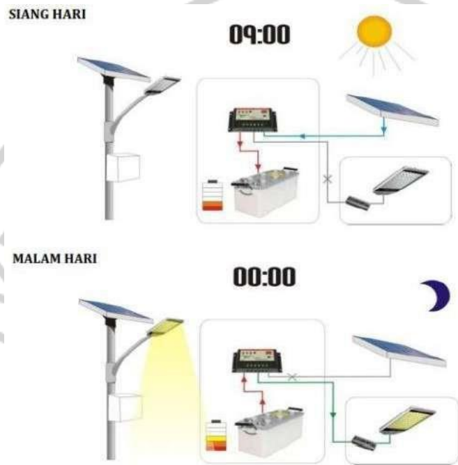
Gambar 2.4 Prinsip Kerja Penerangan berbasis Solar Cell
