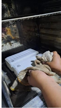
Gambar 3.50 Memasukkan Paving Block ke Oven
