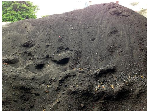
Gambar 4.2 Agregata Halus : Pasir Muntitan
