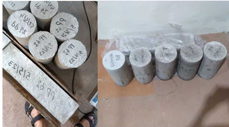
Gambar 3.29 Beton Yang Telah Mengering Dilepas Dari Cetakan
