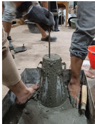
Gambar 3.32 Proses Penuangan Beton
