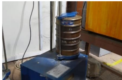
Gambar 3.17 Susunan Ayakan Uji Gradasi
