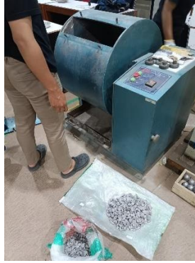
Gambar 3.20 Persiapan Alat dan Bahan Sebelum Pengujian Menggunakan Mesin Los Angeles
