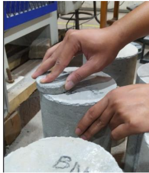
Gambar 3.36 Perataan Permukaan Benda Uji Dengan Batu Gosok
