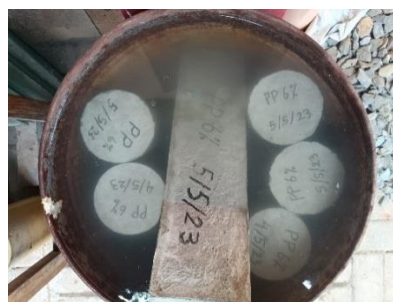
Gambar 3.30 Perawatan Benda Uji Dengan Perendaman Menggunakan Air
