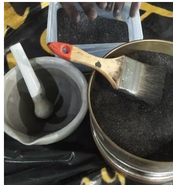
Gambar 3.25 Penumbukan Abu Cangkang Sawit Sebelum Diayak Saringan Nomor 200 / 0,075 mm
