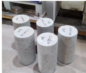
Gambar 3.34 Persiapan Benda Uji Silinder
