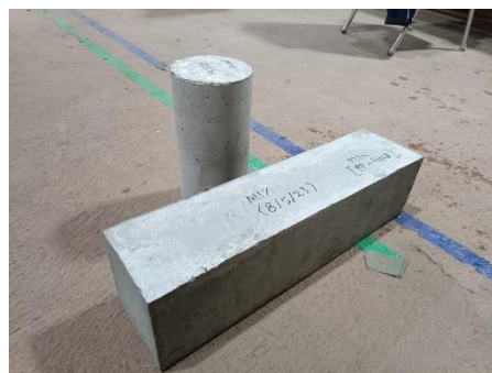
Gambar 3.42 Beton Modifikasi Berbentuk Silinder dan Balok
