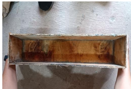
Gambar 3.28 Cetakan Balok Ukuran 15 cm x 15 cm x 60 cm
