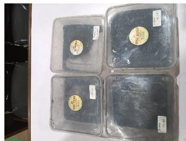
Gambar 3.26 Abu Cangkang Sawit Lolos Saringan Nomor 200 / 0,075 mm
