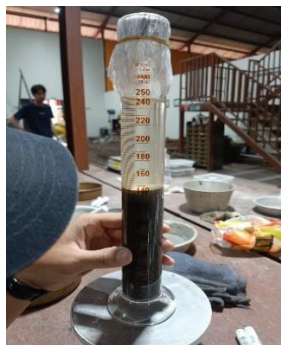
Gambar 3.19 Proses Pengujian Kadar Lumpur Pada Agregat
