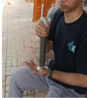
Gambar 3.18 Proses Pengujian Kadar Lumpur Pada Agregat
