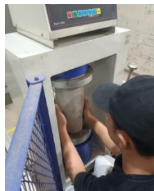
Gambar 3.38 Peletakan Benda Uji Pada Alat Compression Testing Machine .
