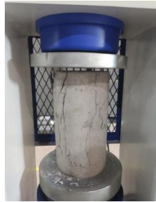
Gambar 3.39 Beton Setelah Di Uji Kuat Tekan
