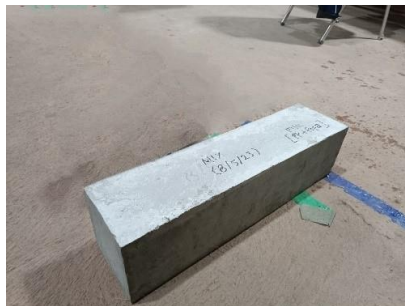
Gambar 3.40 Beton Balok Ukuran 15 cm x 15 cm x 60 cm
