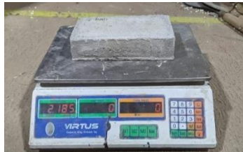
Gambar 3. 35 Penimbangan Benda Uji Setelah Dioven
