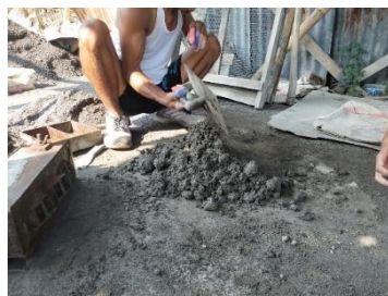
Gambar 3. 18 Campuran Paving block (Pabrik Rumahan)
