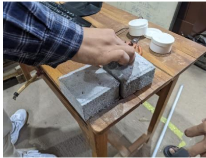
Gambar 3. 29 Grinding Permukaan Benda Uji
