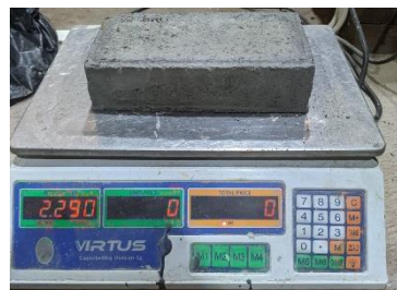
Gambar 3. 33 Penimbangan Paving Setelah Perendaman
