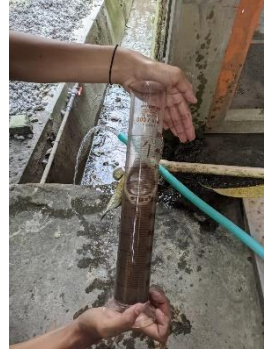
Gambar 3. 14 Pengocokan Benda Uji Kadar Lumpur
