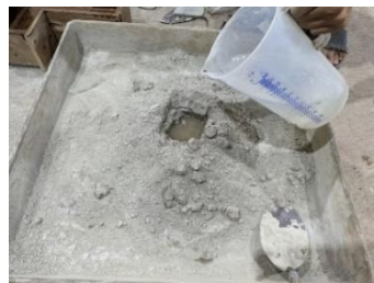
Gambar 3. 25 Penambahan Air dalam Campuran
