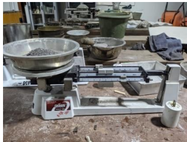
Gambar 3. 4 Timbangan Manual, Koreksi 0,1 gr
