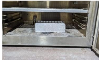
Gambar 3. 34 Pengovenan Benda Uji
