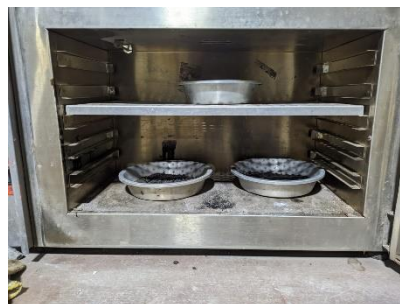
Gambar 3. 16 Pengovenan Benda Uji Kadar Lumpur
