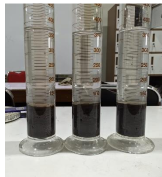
Gambar 3. 15 Hasil Cucian Bersih Pasir
