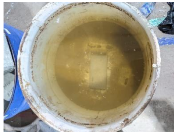
Gambar 3. 32 Perendaman Paving block Dalam Air
