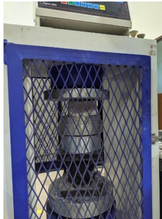
Gambar 3. 30 Benda Uji dalam Mesin Kuat Tekan
