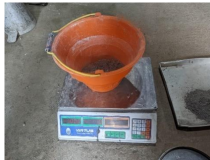
Gambar 3. 10 Penimbangan Sampel Gradasi Pasir
