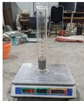
Gambar 3. 13 Penimbangan Benda Uji Kadar Lumpur
