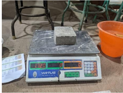
Gambar 3. 28 Penimbangan Benda Uji
