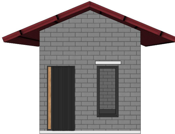
Gambar 3.13 Desain Arsitektural Hunian Menggunakan Tritisan
