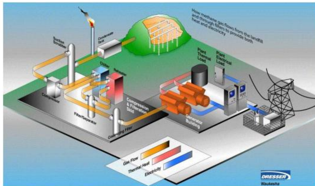
Gambar 2.22 Proyek Pemanfaatan LFG untuk Pembangkit Listrik
