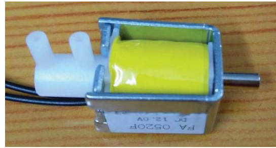
Fig. 6. Selected mini electric solenoid valve
