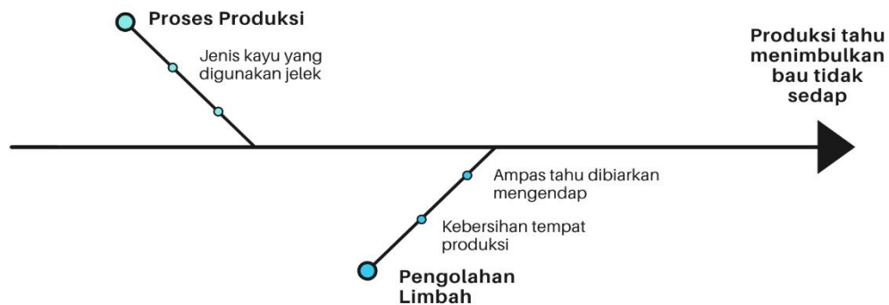
Gambar 1.2 Diagram Fishbone Produksi Tahu Menimbulkan Bau Tidak Sedap
