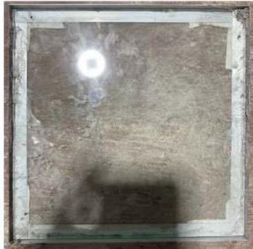
Gambar 3. 12 Cetakan Benda Uji
