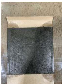
Gambar 3. 32 Proses Pengeringan Benda uji
