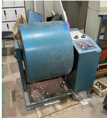
Gambar 3. 24 Proses Penghalusan Menggunakan Los Angeles (Sumber: Dokumentasi Pribadi, 2023)
