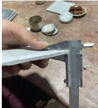
Gambar 3. 35 Pengukuran Tebal Menggunakan Jangka Sorong (Sumber: Dokumentasi Pribadi, 2023)
