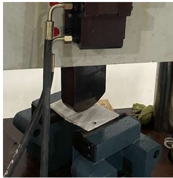
Gambar 3. 38 Benda Uji Ditekan Dengan Kecepatan 50 mm/menit
