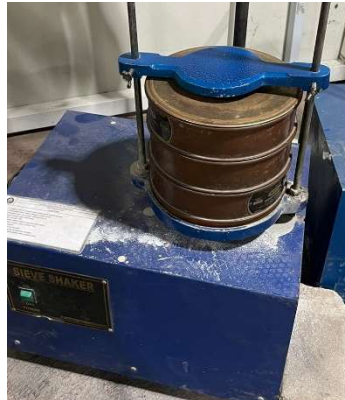
Gambar 3. 26 Proses Saringan Menggunakan Mesin Pengguncang (Sumber: Dokumentasi Pribadi, 2023)
