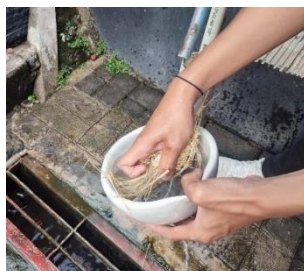
Gambar 3. 13. Serat bamboo dicuci hingga bersih
