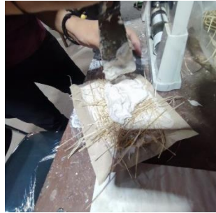
Gambar 3. 26. Tuangkan sisa adonan hingga menutupi serat
