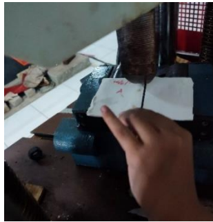
Gambar 3.34 Benda Uji Disejajarkan Dengan Beban
