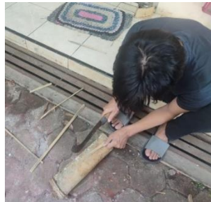
Gambar 3. 12. Ambil serat bamboo dengan cara dipukul
