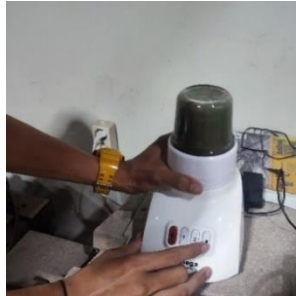
Gambar 3. 8. Haluskan kertas semen menggunakan blender
