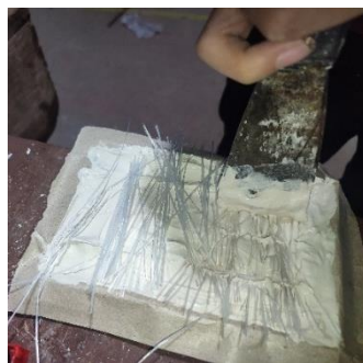
Gambar 3. 25. Tekan serat fiber agar adonan gypsum merata sampai bawah
