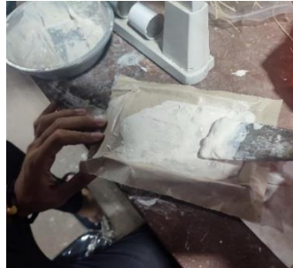
Gambar 3. 23. Tuang gypsum secara bertahap
