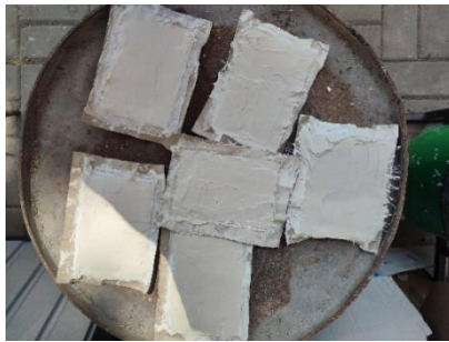
Gambar 3. 6. Gypsum dijemur hingga kering
