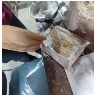
Gambar 3. 24. Masukkan serat bamboo dan serat fiber
