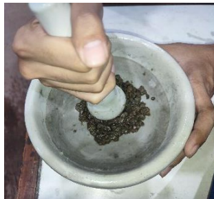
Gambar 3. 9. Haluskan Kembali kertas semen dengan cara ditumbuk
