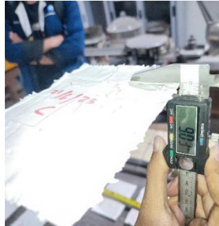
Gambar 3. 50 Pengukuran tebal Benda Uji
