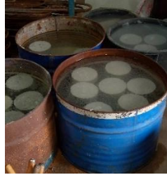
Gambar 3. 53 Beton di rendam
