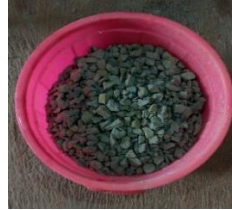
Gambar 3. 36 Split Muntilan lolos saringan 19mm dan tertahan 9,5mm
