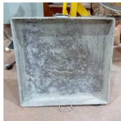
Gambar 3. 42 Loyang untuk menampung beton segar
