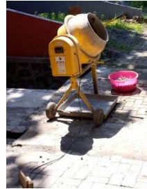
Gambar 3. 49 Tempatkan mixer di tempat terbuka
