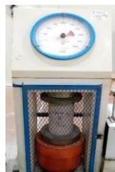
Gambar 3. 58 Beton di uji kuat tekan
