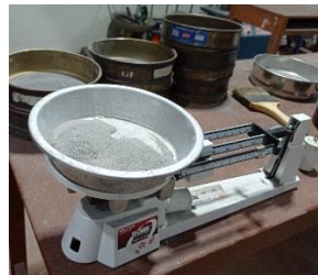
Gambar 3. 9 Menimbang berat agregat halus tertahan
