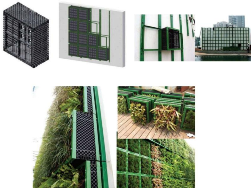
Gambar 2. 6 Konstruksi green wall dan penerapan green facade
