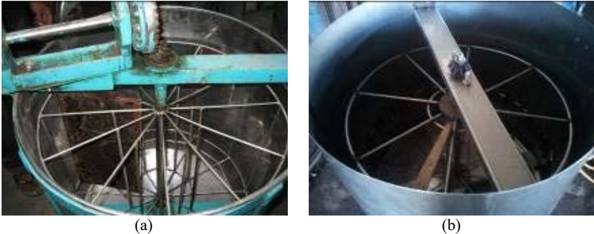
**Gambar 2. Alat pemisah madu kapasitas 24 kg (a) dan 48 kg (b)**
