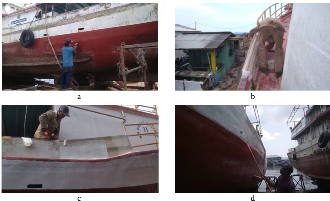
Gambar 2 (a) brushing lambung kapal (b) penambahan bordo kapal (c) laminasi (d) pengecatan
